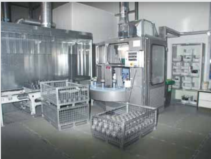
CNC-Bindemittelanlage · CNC bonding agent application · CNC application de l'adhésif
