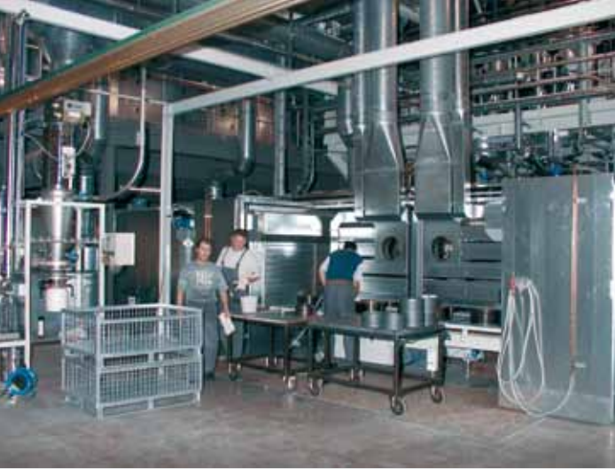
Langlaufgießofen · Longitudinal casting oven · Four de coulée longitudinal
